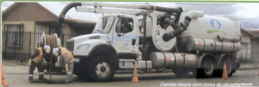
Camión limpia colectores de alcantarillado
